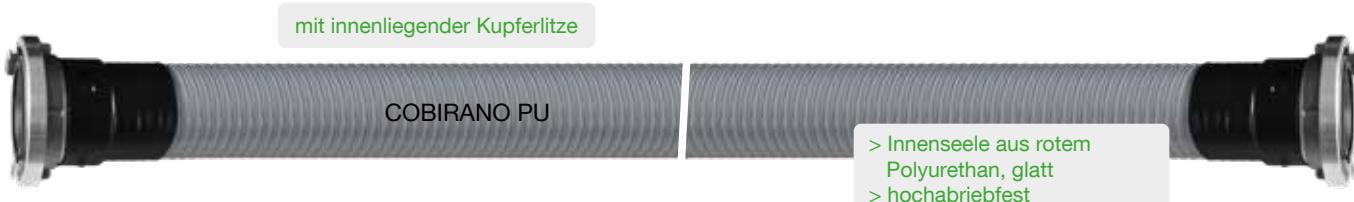
Unsere Holzpellets-Betankungsschläuche sind komplett eingebunden mit beidseitig System Storz 110-A. Die Storzcupplung wird speziell von außen mit dem Schlauch verschraubt. Es entsteht eine hundertprozentig glatter Durchgang wodurch es zu keinen Verwirbelungen oder Beschädigungen des Mediums kommt. Zusätzlich wird der Schlauch von außen durch einen Schrumpfschlauch abgedichtet, so dass die Schlauchleitung im Einsatz keine falsche Luft ansaugen kann.
